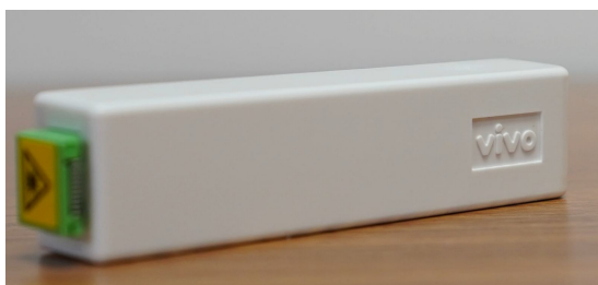
PONTO DE TERMINAÇÃO ÓPTICA - PTO
