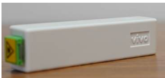
PONTO DE TERMINAÇÃO ÓPTICA - PTO
